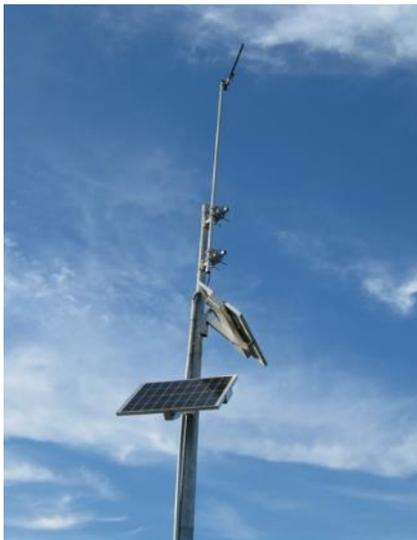
Figure 4: Station de surveillance du débit d'eau potable. Panneaux solaires et antenne directionnelle
